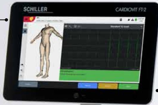
Leichtere EKG-Aufzeichnung dank dem anatomischen Assistenten zum Anlegen der Elektroden, der farbkodierten Signalprüfung der Ableitungen und der Erkennung vertauschter Elektroden
